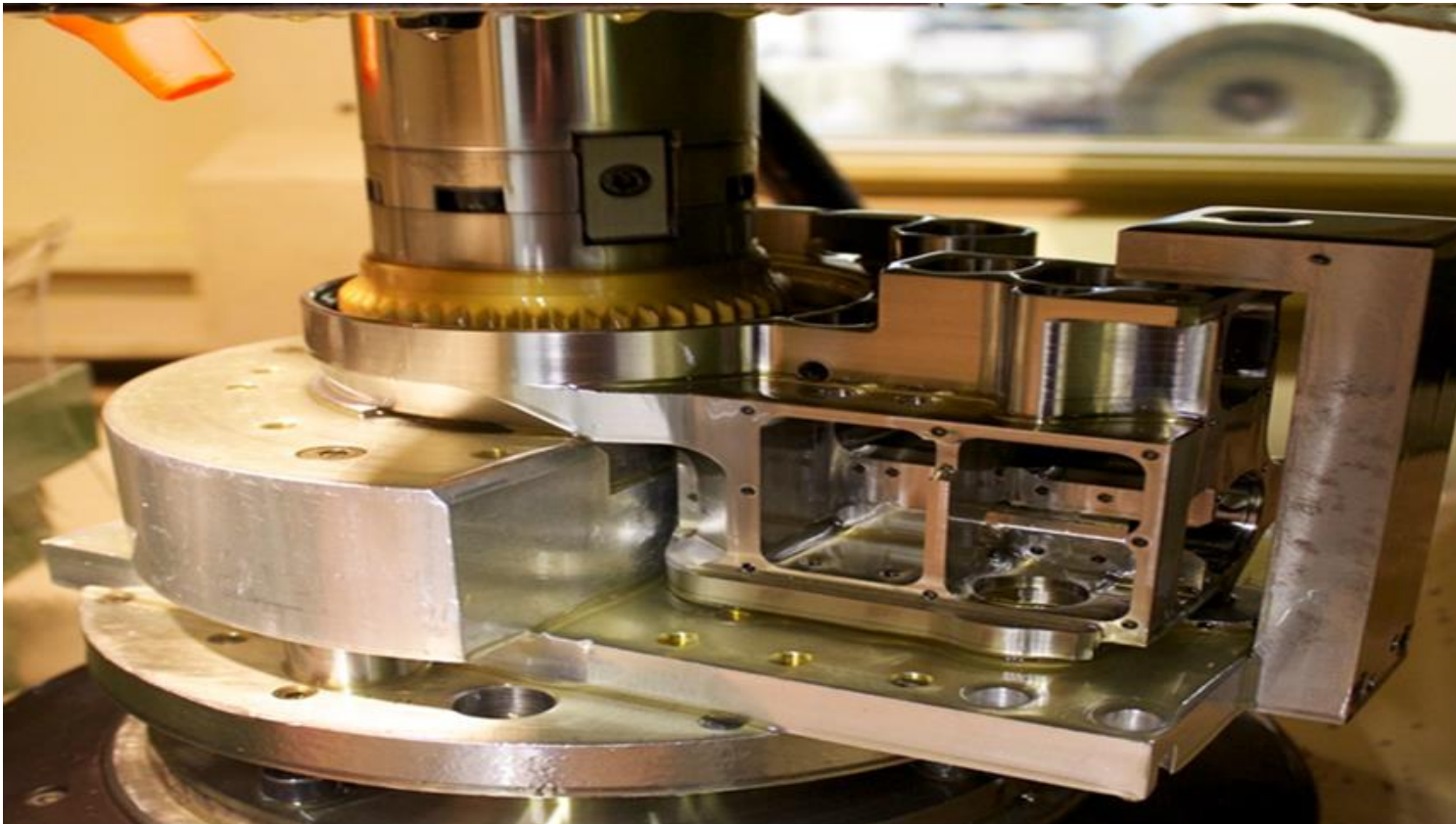
Taillage couteau Fellow numérique sur un carter en titane (Programme NH90)
